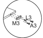
**Parafuse a chapa nos furos laterais e rosqueie a sapata no furo central.**
