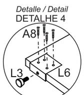
**Encaixe o suporte na peça e parafuse. após rosqueie a sapata.**
